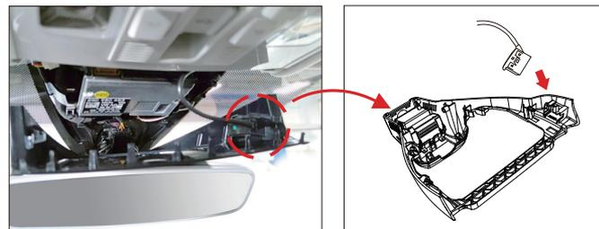
(3)主线束上的线束插头与DVR对插，将对接的插头用绝缘胶布固定。整理走线，注意避免过紧拉扯线束。
