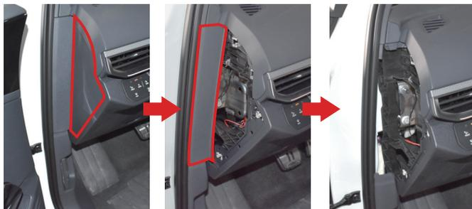
(3) 按顺序拆下引擎盖手柄开关、引擎盖手柄开关后饰板。
